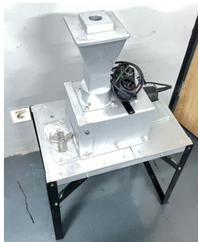
Gambar 4. Tampak hasil pembuatan prototipe mesin penggiling jagung sederhana.
