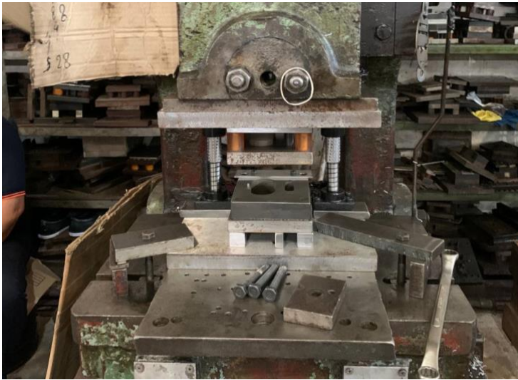
Gambar 12. Hasil pemasangan dies pada mesin press.
