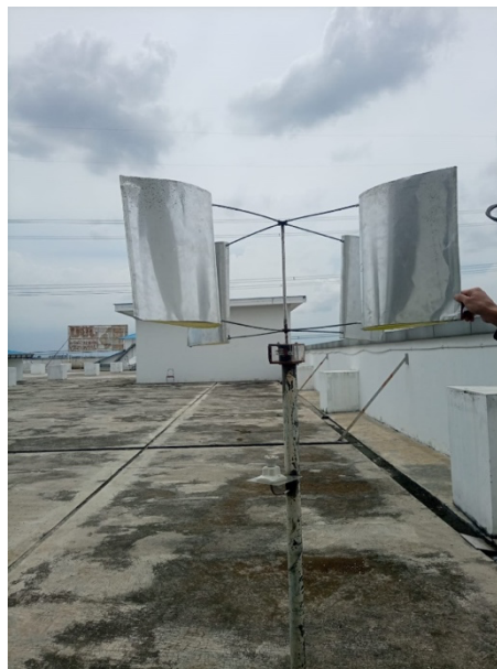
Gambar 4. Pengujian daya dan kecepatan angin dengan jumlah sudu 4 buah, panjang lengan 35 cm, dan lebar sudu 35 cm.
