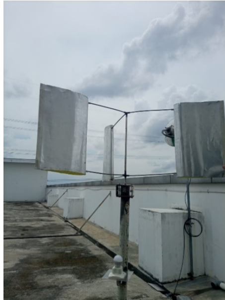
Gambar 2. Pengujian daya dan kecepatan angin dengan jumlah sudu 3 buah, panjang lengan 30 cm, dan lebar sudu 30 cm.
