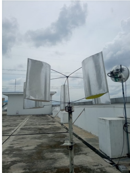
Gambar 6. Pengujian daya dan kecepatan angin dengan jumlah sudu 5 buah, panjang lengan 40 cm, dan lebar sudu 40 cm.
